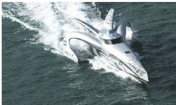
Producenterne af »Earthrace« kalder den selv en "bølge-gennemtrængende trimaran". Den er 24 m lang og har en rækkevidde på 3.000 sm. Skroget består af kulfiber og kevlar. Foto: Jim Burkett
