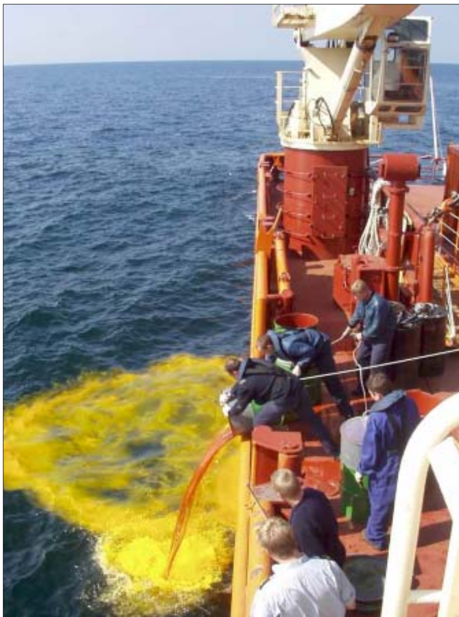
Om eftermiddagen blev der gennemført en række testforløb, hvor forudbestemte mængder af rapsolie blev hældt i vandet.
